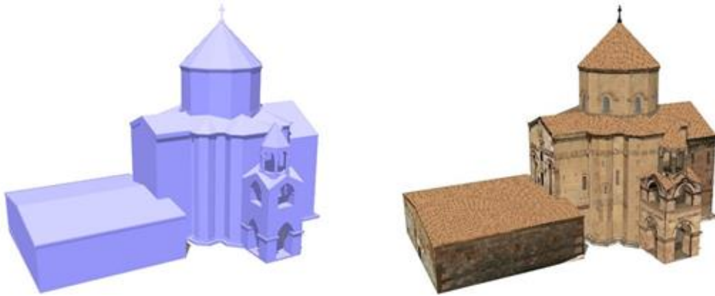
Şekil 7. Akdamar Kilisesi'nin 3B katı modeli (sol) ve yüzey dokuları uygulanmış 3B modeli (sağ)
