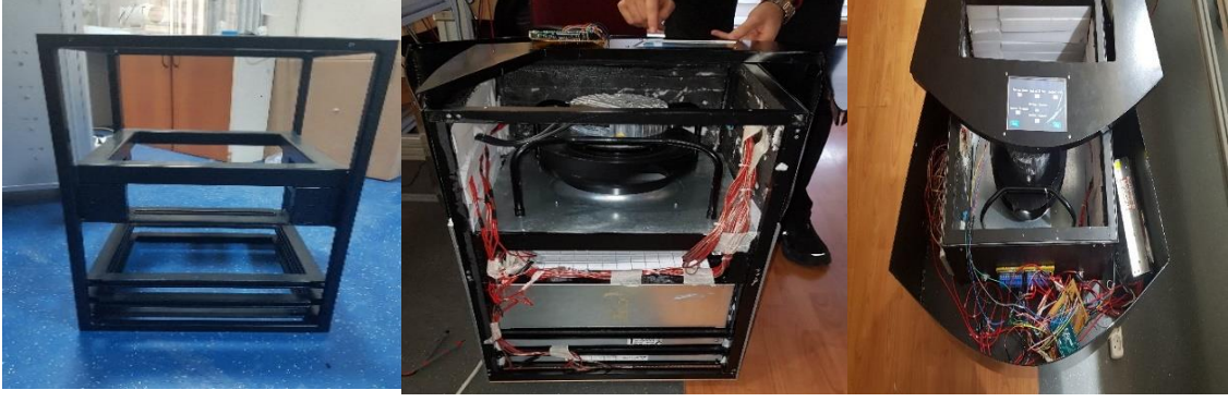
Şekil 5. Cihazın şase, motor, filtreler, UV-C'lerin ve elektronik bileşenlerinin gösterimi
