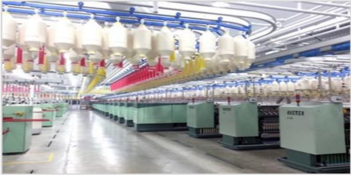
Şekil 5. İplikhanede fitil yumaklarının otomatik taşınması
