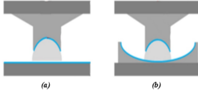
Şekil 1. (a) Düz yüzeyli ve (b) eğri yüzeyli sürtünmeli sarkaç izolator
