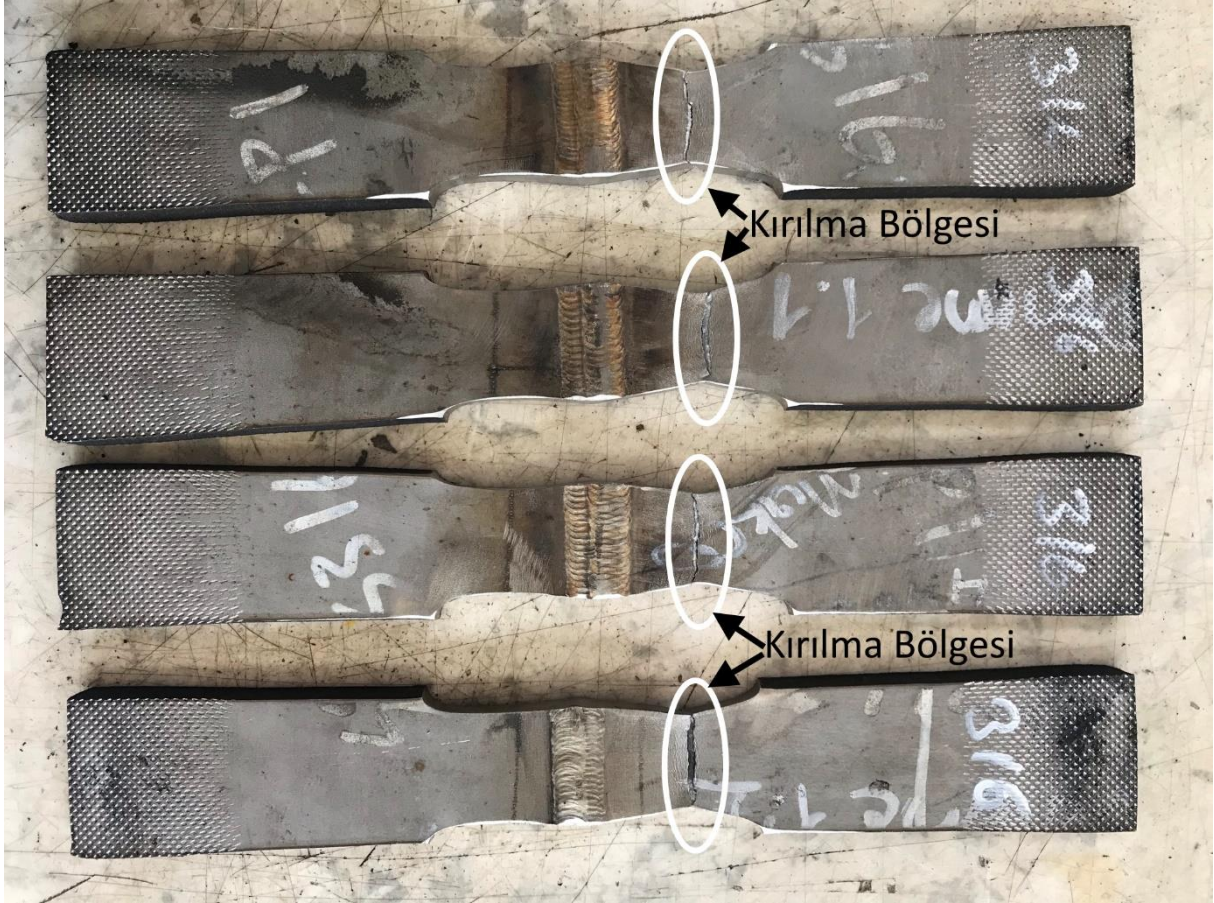
Şekil 8. Kaynaklı bağlantı numunelerinde kırılma bölgelerini gösteren makro resimler (Şekildeki oklar kırılma noktalarını göstermektedir).
