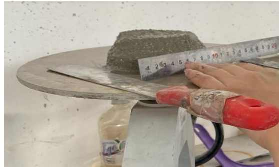
Şekil 1. Yayılma tablası deney düzeneği
