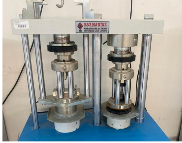
Şekil 2. Deneyde kullanılan eğilme ve basınç dayanımı presi
