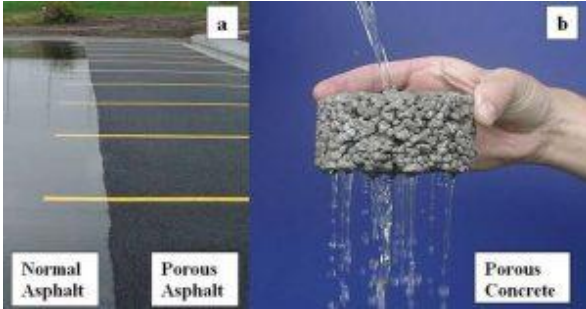
Şekil 4: Geçirgen asfalt – beton (URL8 )
