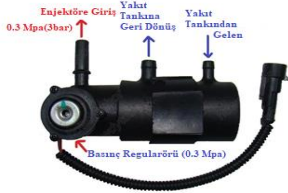
Şekil 7. Yakıt pompası
