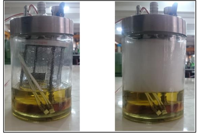
Şekil 4. Atomizerin aktif ve pasif durumları için depodaki yakıtın görünüşü
