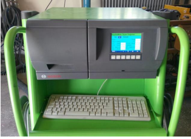
Şekil 2. Bosch BEA 350 egzoz emisyon analiz cihazı
