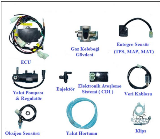
Şekil 6. Enjeksiyon sistemi parçaları
