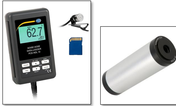
Şekil 3. Gürültü Ölçüm Aleti ve Kalibratör
