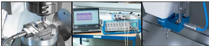
Şekil 9. CNC Frezeler İçin Özelleştirilmiş Kesme Kuvveti Ölçme Cihazları (Kistler, 2019)
