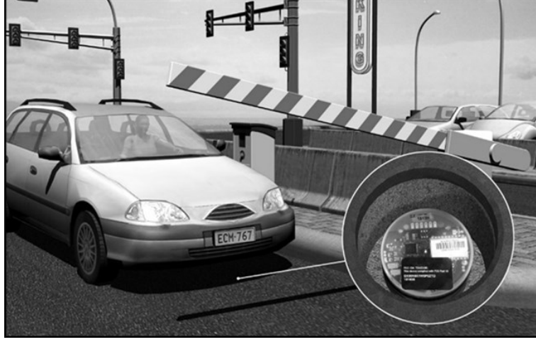
řekil 2. Otopark giriřinde magnetometre ile ara sayım uygulaması (Banner, 2019).
