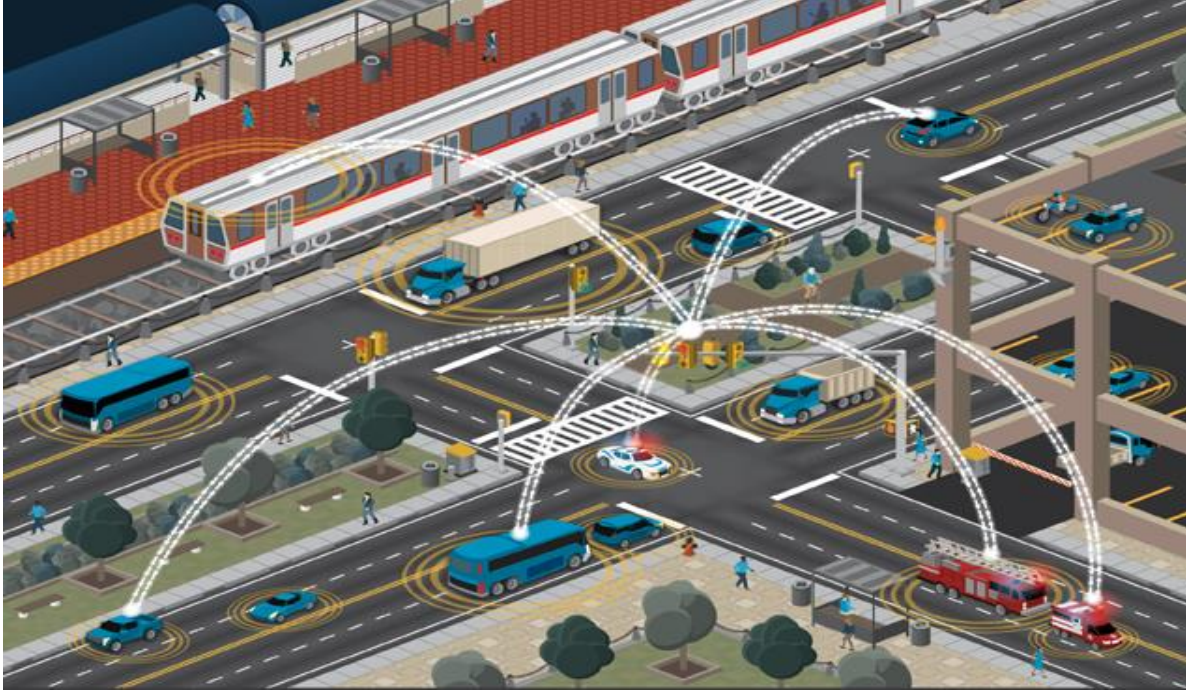
Şekil 5. Araç-Altyapı iletişimi (V2I)
