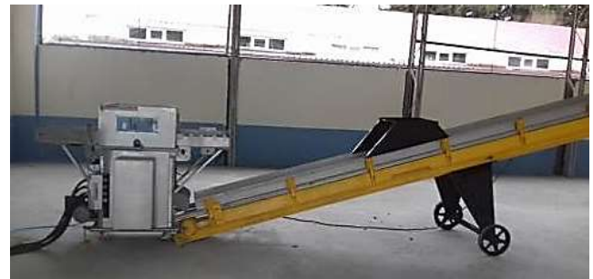
Şekil 14. Şişe boşaltma makinesi
