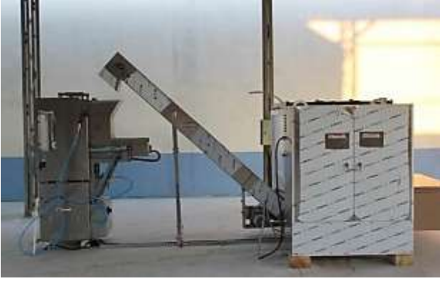
Şekil 4. Şişe doldurma makinesi
