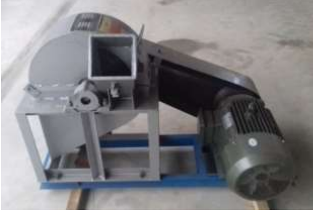
Şekil 2. Odun ve mısır koçanı öğütücü
