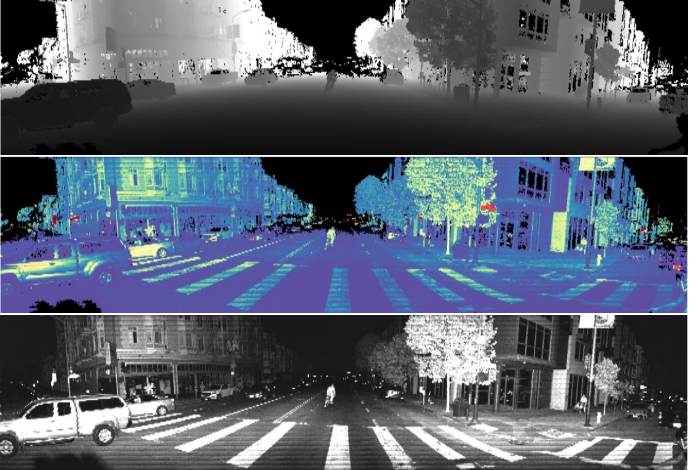
Şekil 12. Ouster OS1 nokta bulutu verisinden üretilmiş 2B mesafe (üst), yansımaya (orta), sinyal (alt) değerleri görüntüsü
