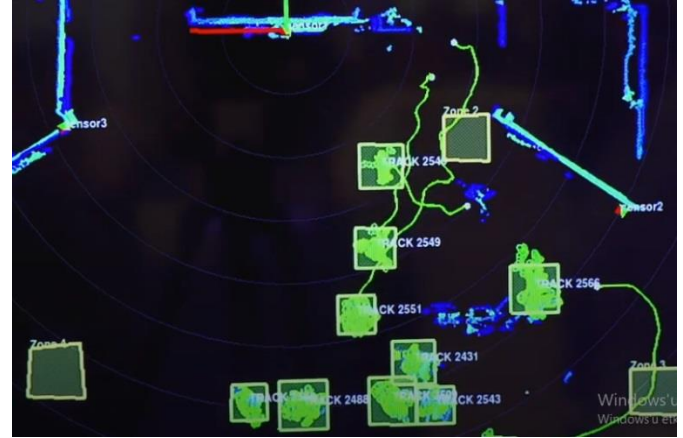
Şekil 7. Farklı noktalara yerleştirilen lazer tarayıcı ile kişi tespiti ve takibi [29]
