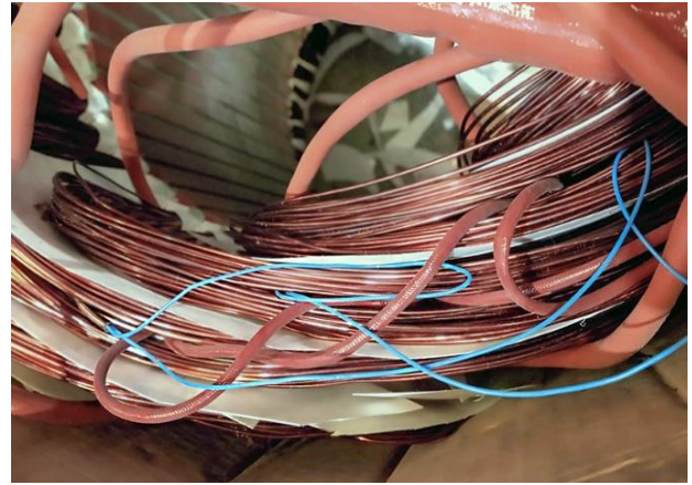
Şekil 3. Motor sargıları arasına PT100 yerleştirilmesi
