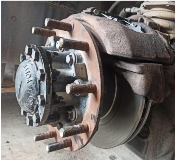
Şekil 1. Şehir içi alçak tabanlı otobüse ait arka fren diski.
