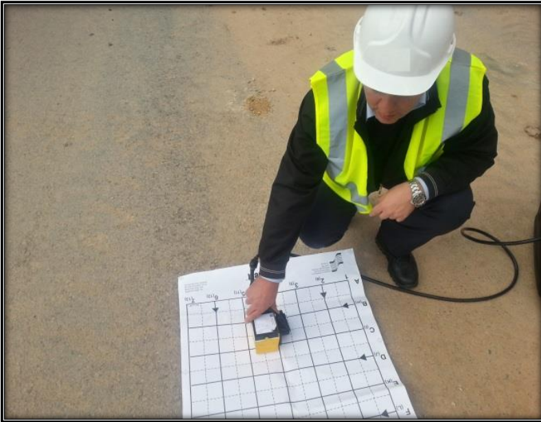
Şekil 9. TR HF (2 GHz) Anteni kullanılarak köprü üzerinde GPR arařtırması
