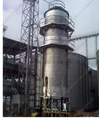
Şekil 5. Kule tipi (dikey) mısır kurutma makinesi (Web_3)
