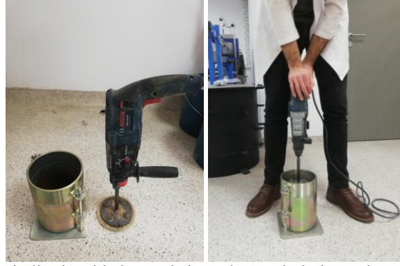
Şekil 6. Titreşimli tokmakla kompaksiyon deney aletleri ve tokmağın uygulandığı
