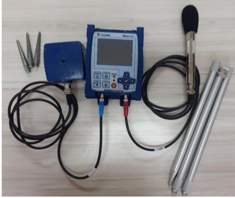
Şekil 5. “Instantel Micromate” titreşim ve gürültü ölçüm cihazı
