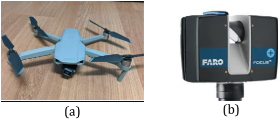
Şekil 3. (a) DJI Mavic Pro 2, (b) Faro Focus Lazer Tarayıcı
