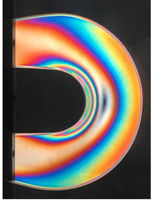
Şekil 1. Eğri eksenli çubuk numunesi fotoelastik analizi
