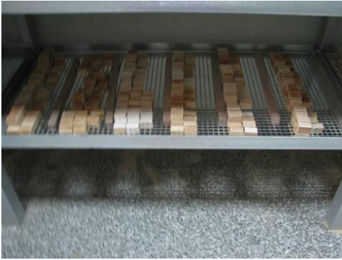
Şekil 2. Yoğunluk tayini için hazırlanan örneklerin iklimlendirme odasında %12 nem oranına ininceye kadar bekletilmiştir
