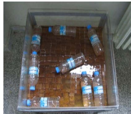
Şekil 3. Daralma deneyi için hazırlanan örnekler suda bekletilmiştir
