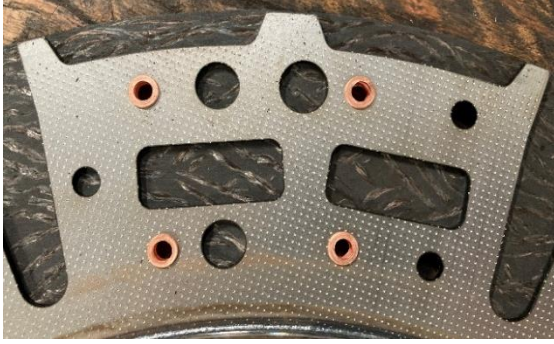
Şekil 3. CAD ve Gerçek Görünümde Batmalı Ana sac-Balata Montajı.
