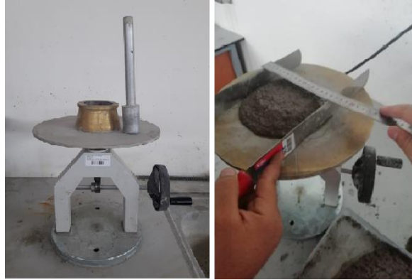
Şekil 1. Yayılma tablası deney düzeneği.
