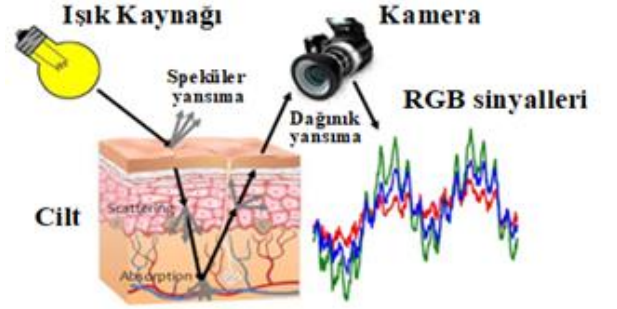
Şekil 1. Ciltten yansıyan PPG sinyalinin kamera tarafından yakalanması (Wang, 2017).
