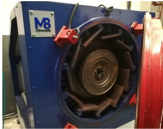
Şekil 13. Volanın burst testi makinesine bağlanması(Connecting the flywheel to the burst testing machine.)
