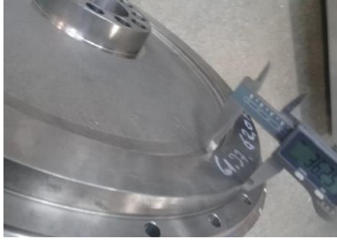
Şekil 10. Volanın işlenmeden önceki hali (The state of the flywheel before processing)
