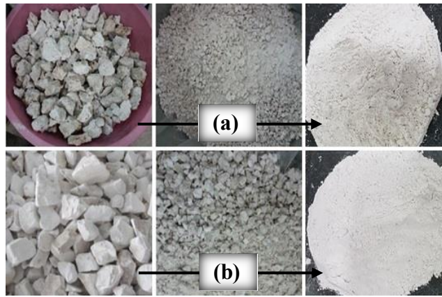
Şekil 1. KK (a) ve DK'nın (b) boyut küçültme süreci (Size reduction process of CL (a) and DL (b))
