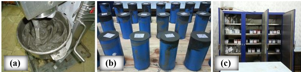
Şekil 2. Kullanılan mikser (a), ÇMD numunelerinin drenaj (b) ve kür işlemi (c) (Mixer (a), drainage (b) and curing process (c) of CPB samples)
