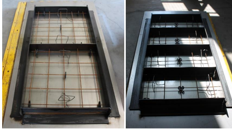
Şekil 2. Standart numunelerin modüler çelik kalıpları (Modular steel molds of standard specimens)
