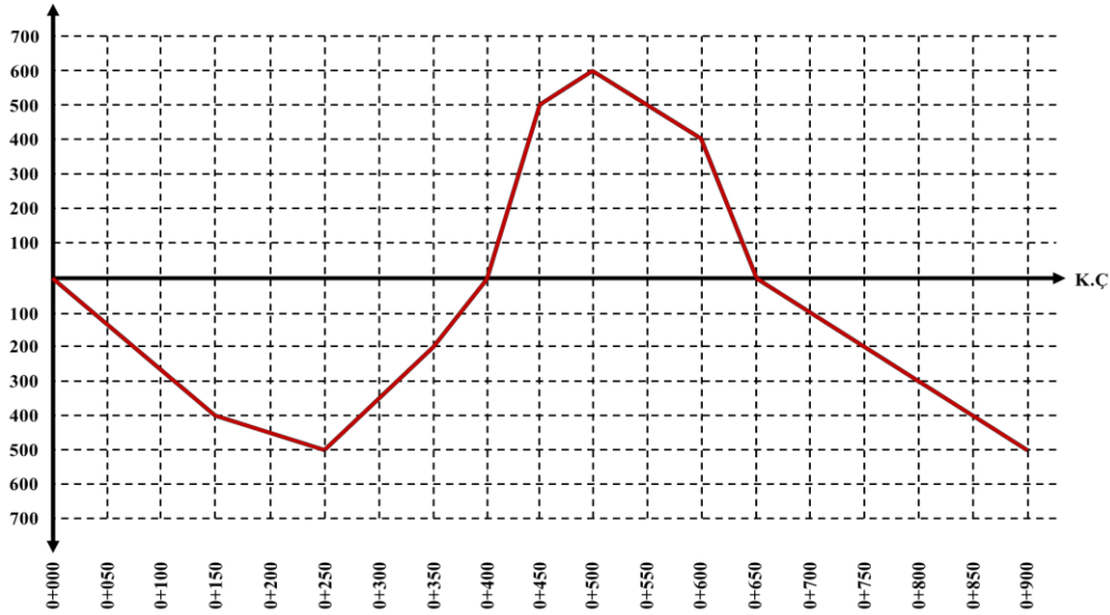
Şekil 7. Örnek 1 için Kütleler Diyagramı (Mass Diagram for Sample 1)
