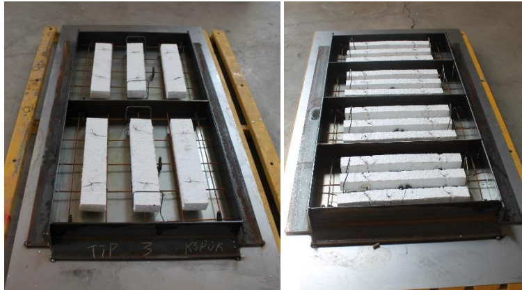
Şekil 3. EPS dolgulu numunelerin modüler çelik kalıpları (Modular steel molds of EPS infilled specimens)
