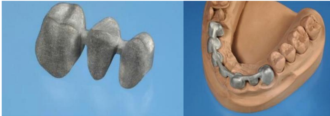
Şekil 3. CoCrMo alaşımının dental alandaki uygulaması [31]
