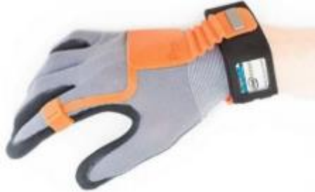
Şekil 6: RFID okuyucu entegre edilmiş eldiven Kaynak:(Mocan & Draghici, 2018)
