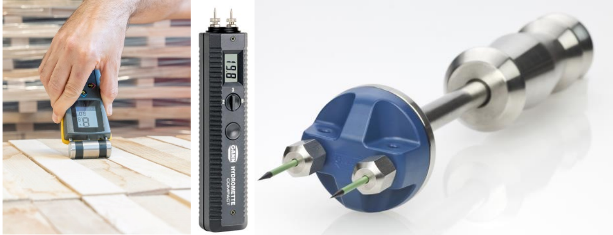
Şekil 4. Dielektrik (kapasitans - temas) tip (solda) (Logica, 2023), (ortada ve sağda) Sırasıyla kısa (GANN, 2023a) ve uzun çivili (GANN, 2023b) direnç tipi rutubet ölçerler
