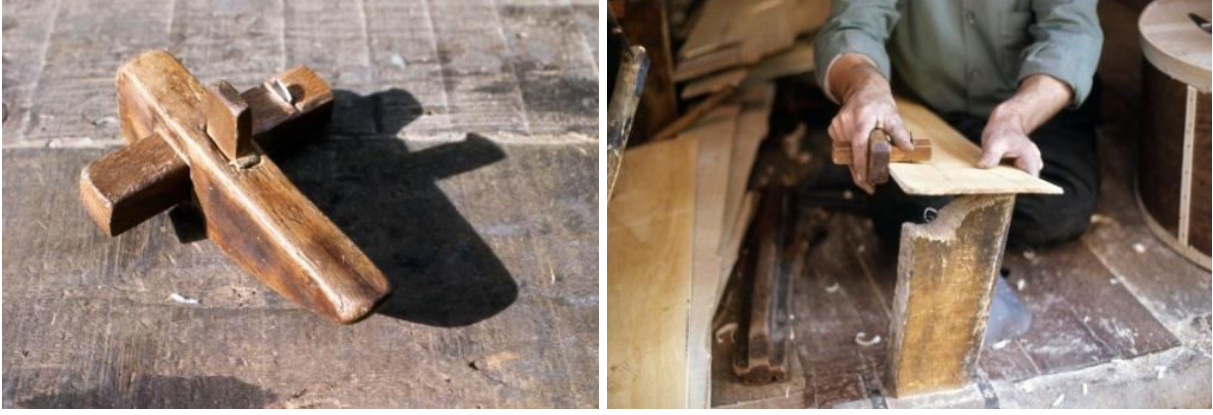
Şekil 29: Kuzey Doğu Anadolu'dan ayarlı ahşap nişangeç.
