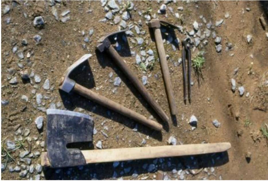
Şekil 30: Ortada, bu kesiciler, aslında her türlü ahşabın değişik yarıçaplarda işlenmesine olanak verecek biçimde gelişmiştir. (Ö. Küçükerman Arşivi)
