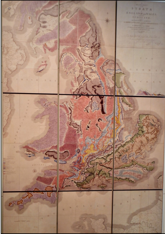
Resim 2. William Smith tarafından her yıl binlerce kilometre yol gidilerek oluşturulmuştur. Smith kayalıkların zemin ya da tabakaların dizilişleri ile olan bağlantısını ortaya koymuştur ve bunlar içerisinde bulunana fosil türlerinden yola çıkarak farklı tabakaları tanımlamıştır. Bu bilgileri kullanarak ülke boyunca farklı tabakaları ifade eden renklendirmeye haritalandırmayı yapmıştır. Haritanın bir örneği Londra Doğa Tarihi Müzesi'nde sergilenmektedir. Fotoğraf: Damla Ülker, kişisel arşivi.
