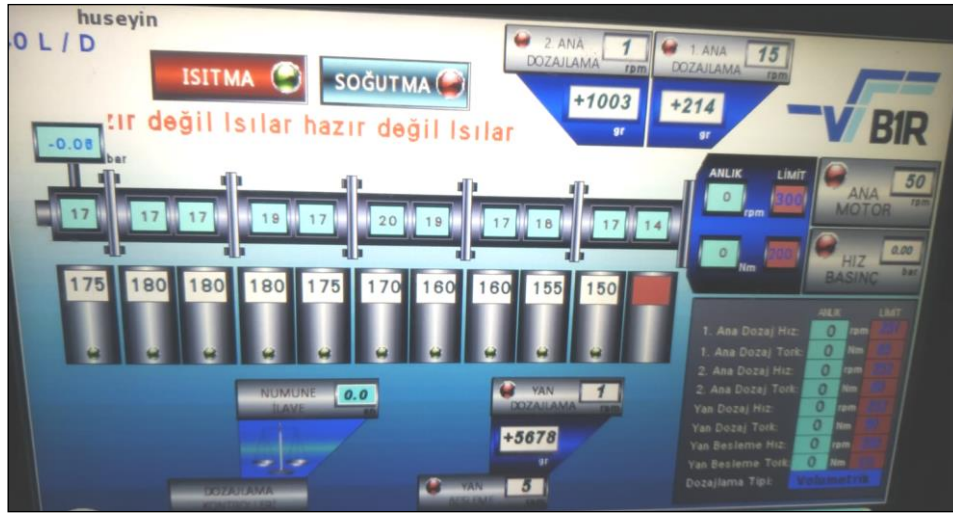
Şekil 2. Ekstrüzyon proses değerleri.
