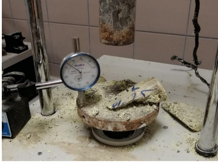
Şekil 5. Serbest Basınç Deneyi Zemin Numunesi Kırılma Paterni
