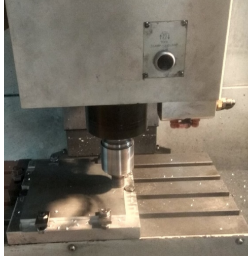
Şekil 1. Sürtünme karıştırma kaynağı uygulaması (Friction stir welding application)
