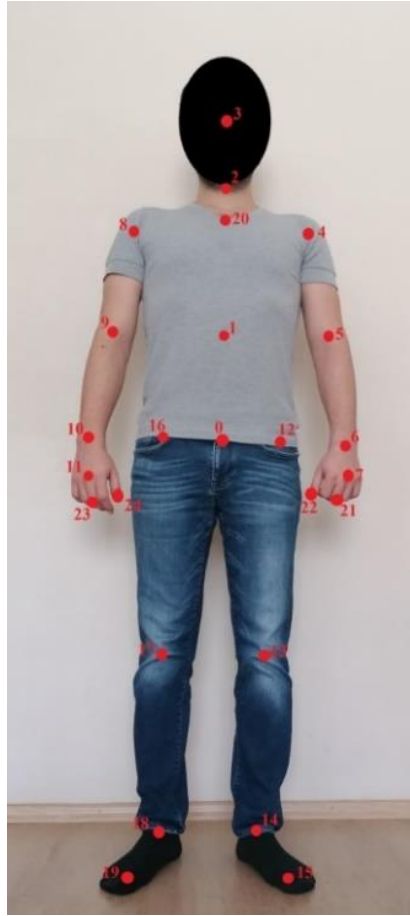
Şekil 2. Kinect 2 ile algılanan eklemler (Figure 2. Joints detected with Kinect 2)
