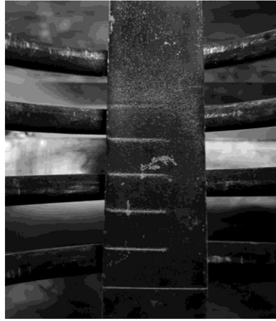
Şekil 3. Manyetik sıvı ile yıkanan referans bloğunun UV ışık altındaki görüntüsü.
