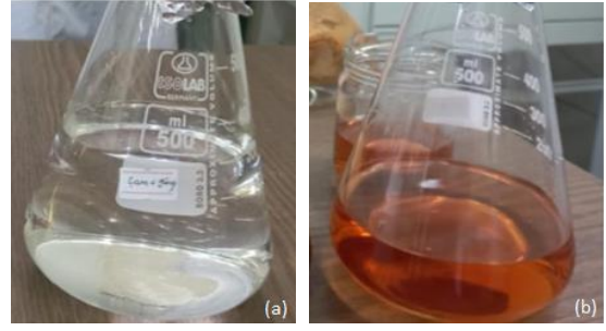
Şekil 1. (a) Kızılcam ekstresi ile \text{AgNO}_3 çözeltisi karıştırıldığı andaki renksiz karışım ve (b) 24 saat sonra oluşan turuncu renkli biyosentetik gümüş nanopartikül koloidal çözeltisi.
