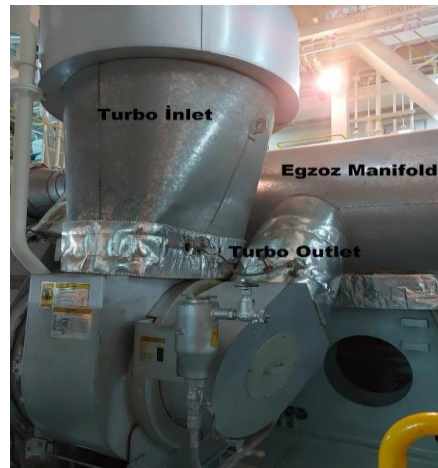
Şekil 6. Ana makine egzoz manifold – turbo inlet, outlet
