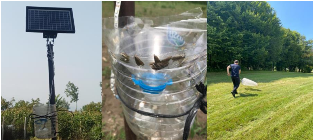
Şekil 1. Loxostege sticticalis erginlerini yakalamak amacıyla kullanılan ışık tuzakları ve atrapla örneklemeye yöntemi
