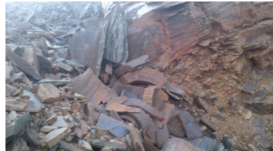
Şekil 4. Tünel giriş kesimi ileri derecede eklemlı şistler (Çakmak Fm.)
