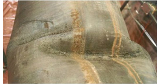
Şekil 5. Boruların lokal burkulması [14]
