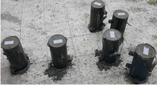
Şekil 1. Kalıplanan silindirik beton numunelerden birkaçı
