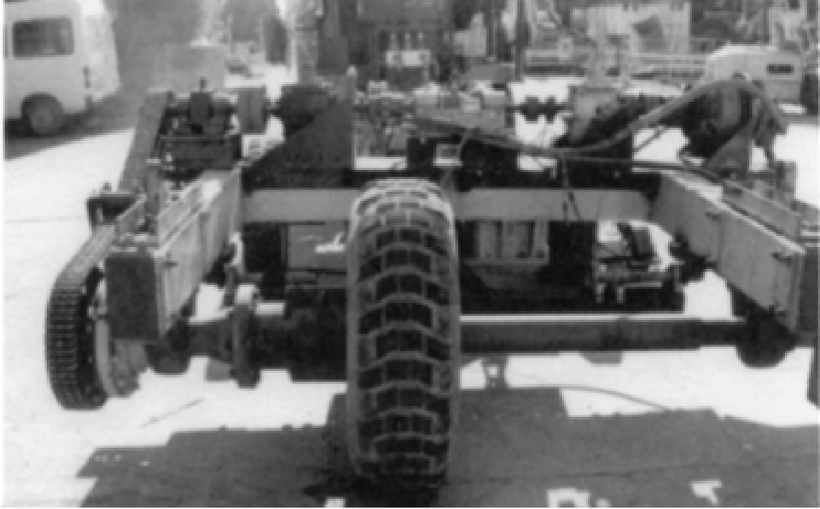
Şekil 7. Shmulevich ve Osetinska'nın (2003) geliştirdiği farklı zeminlerde kullanılabilen deney düzeneği
