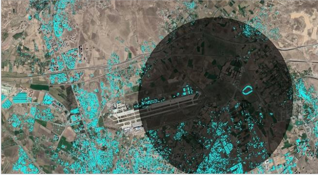
Şekil 13. VOR BRA yüzeyi ve yapılaşma dokusu.
