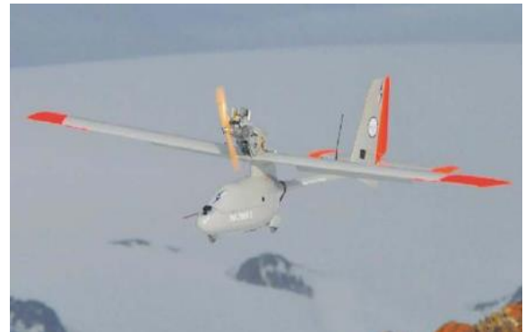
Şekil 13. Çalışmada kullanılan PW-ZOOM model sabit kanatlı İHA
