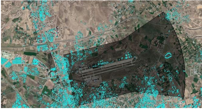
Şekil 14. LLZ25 BRA yüzeyi ve yapılar
