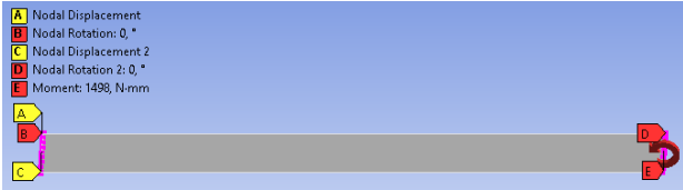
Şekil 4. Model üzerinde uygulanan moment ve sınır şartları.
