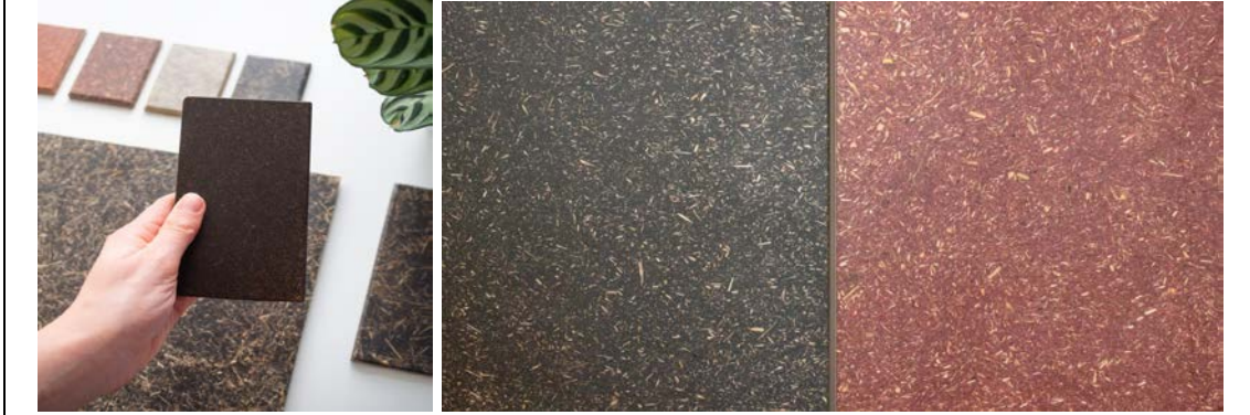
Resim 2.9. Sirküler malzeme paneli numuneleri ve siyah ve kırmızı kamıştan üretilen sirküler malzeme paneli örneği (URL11)
