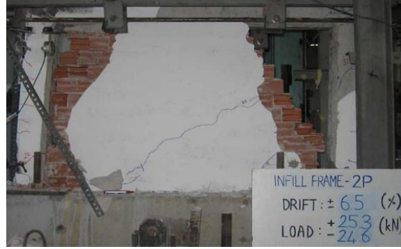
Şekil 20: Deneyler sonrası numune 3 hasar durumu.
