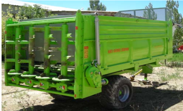
Şekil 2. Araştırmada kullanılan yatay ve düşey tamburlu çiftlik gübresi dağıtma makinesi
