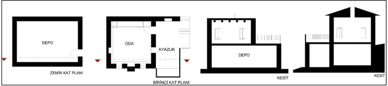
Şekil 10. Ayazlıklı, tek odalı, toprak damlı veya ahşap çatıklı konutların mimari kurgusu (Kaynak: Çalışma kapsamında yazar tarafından oluşturulmuştur).
