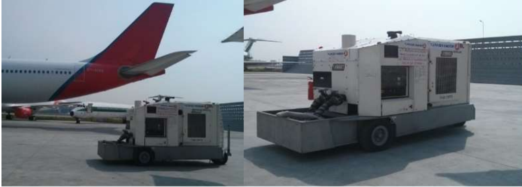
Şekil 2. Harici Hava Üreten Jeneratör
