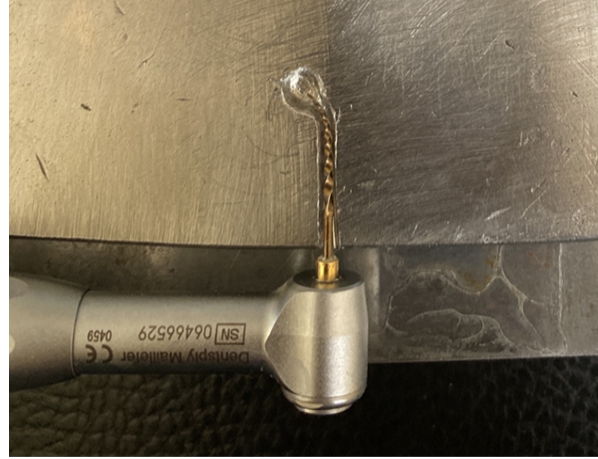
Şekil I. Döngüsel yorgunluk test düzeneği
