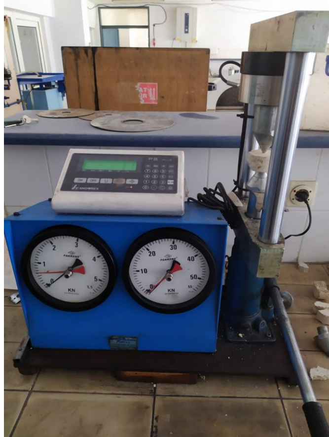
Şekil 10. Nokta yükleme dayanım cihazının gösterimi Figure 10. Illustration of point load strength device
