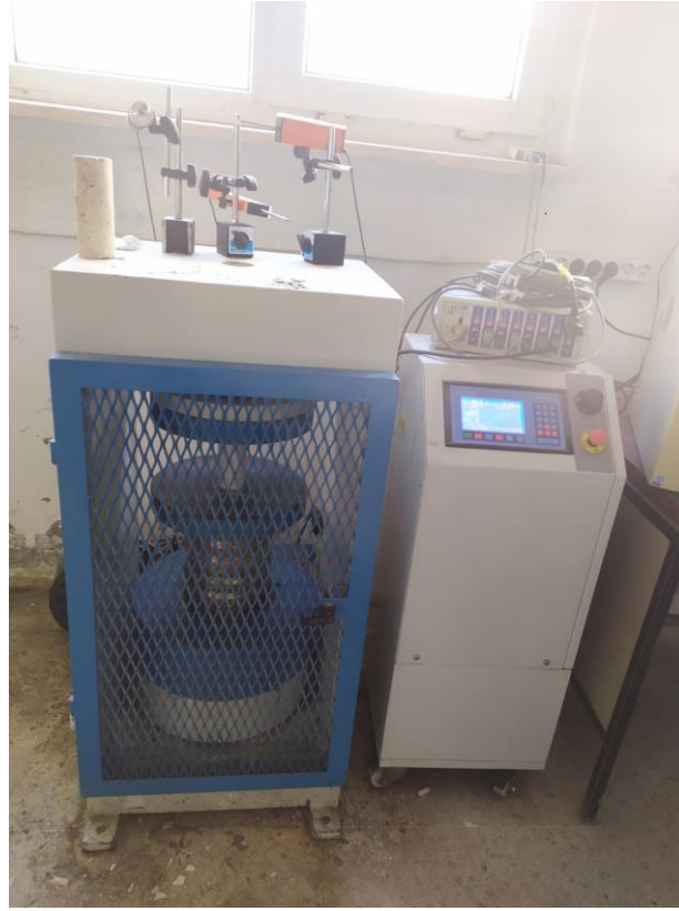
Şekil 9. 3000 kN kapasiteli hidrolik pres Figure 9. Hydraulic press with 3000 kN capacity
