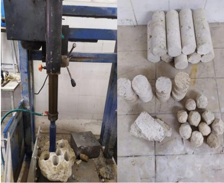
Şekil 7. Kayaç örneklerinden alınan karotlar ve kullanılan karot alma makinesi
