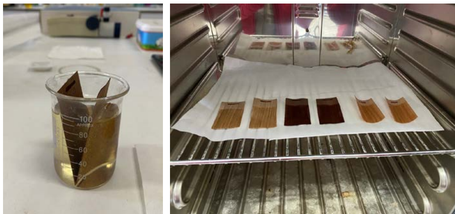
Şekil 1. Fonksiyonelleştirilmiş ahşap kaplamaların daldırılması ve kurutulması
