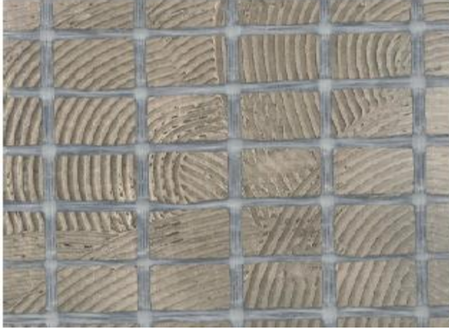
Figür 16. Duvar elemanlarının takviyesinde kullanılacak uygulama 2 yönlü cam elyaf takviye filesi
