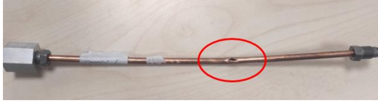
Şekil 3. Patlatma testi sonrası parçanın örnek görüntüsü
