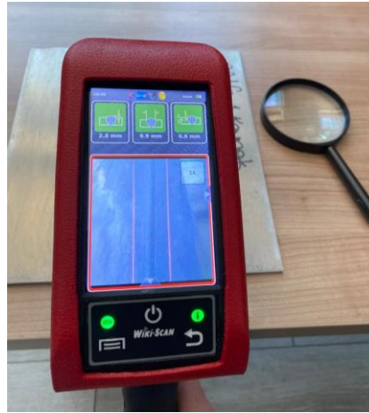
Şekil 11. Servo-Robot marka Wiki-Scan lazerli kaynak ölçüm cihazı ve mercek
