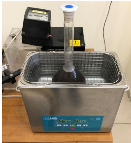
Şekil 2. Nanoakışkan çözeltisine uygulanan ultrasonik banyo işlemi
