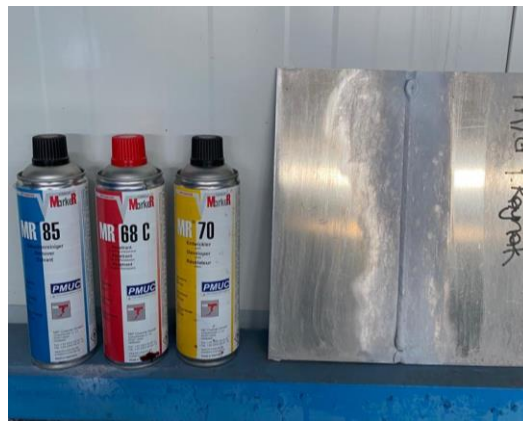
Şekil 3. Penetrant ürün ailesi ( MR 85 alkol, MR 68C penetrant sıvısı, MR 70 geliştirici)
