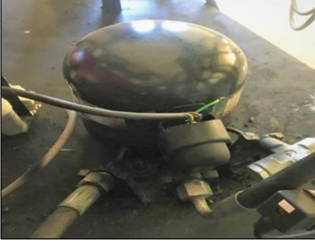
Şekil 3. Hermetik kompresör ve bağlantıları Figure 3. Hermetic compressor and junctions
