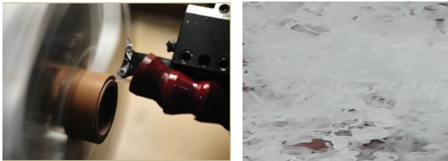
Şekil 7. Floropolimerlerin talaşlı imalat yöntemi ile işlenmesi ve açığa çıkan talaş atıkları
