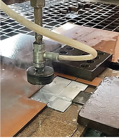
Şekil 3. Su Jeti ile Kesim
