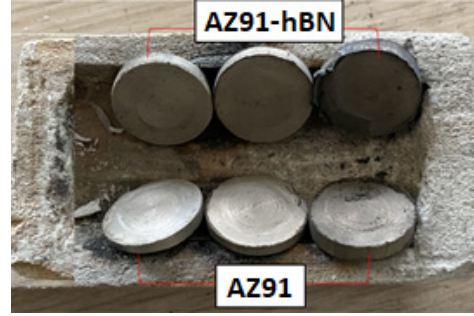
Şekil 1. Sinterleme işlemi tamamlanan numuneler (Samples with completed sinterings).
