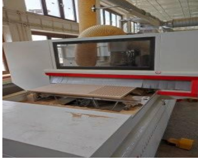
Şekil 2. Ahşap esaslı kompozit panelin çekirdek katmanının CNC Ağaç işleme makinesinde işlenmesine ait görüntü
