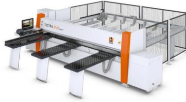
Şekil 1. Önden yüklemeli CNC yatay ebatlama makinesi (URL 2)
