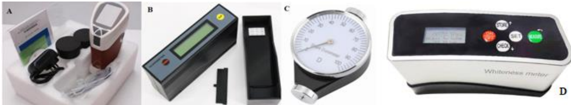
Şekil 1. A: Renk ölçüm cihazı, B: parlaklık ölçüm cihazı, C: sertlik cihazı, D: beyazlık cihazı
