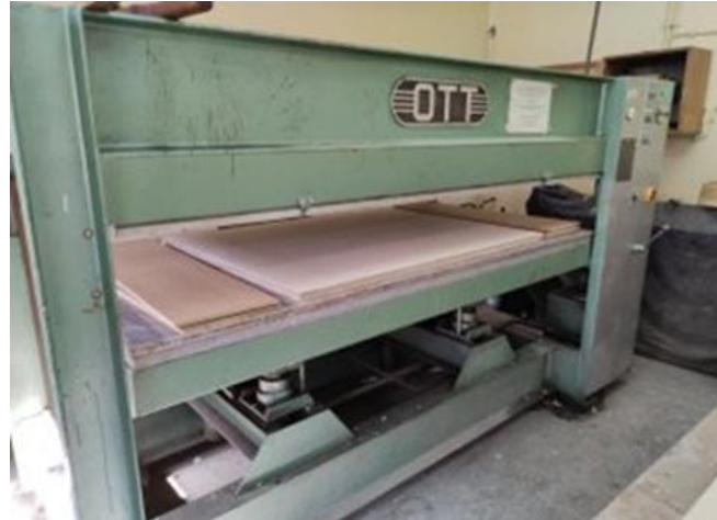
Şekil 3. Ahşap esaslı kompozit panellerin preslenmesi
