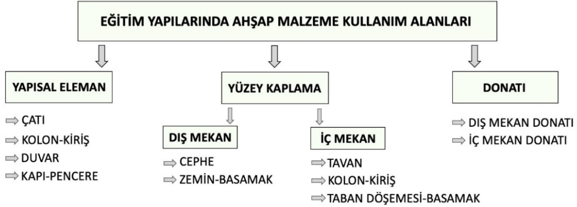
Şekil 1. Eğitim yapılarında ahşap malzeme kullanım alanları.
