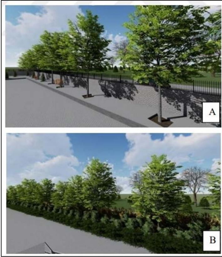
Şekil 6. İstanbul Ticaret Odası Şehit Mustafa Gözütok Ortaokulu gürültü perdesi tasarımı (A: Tasarım öncesi, B: Tasarım sonrası).
