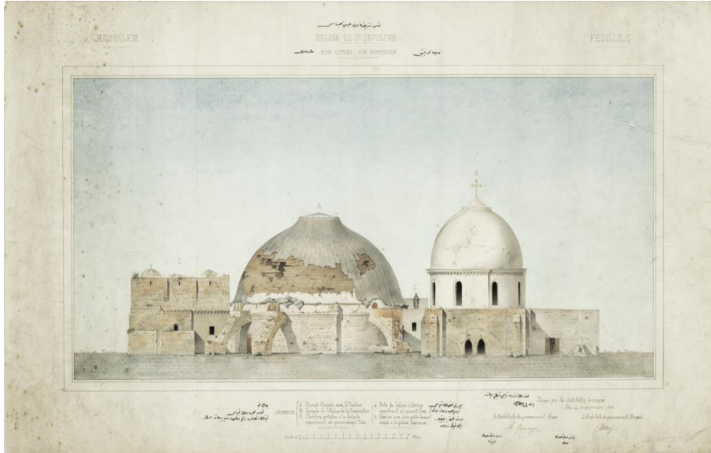
EK.1. Kilisenin Onarımı için yapılan proje çizimleri.
