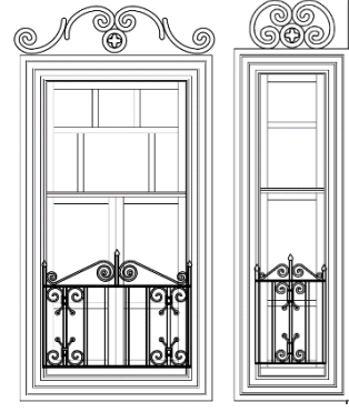
Çizim 10-11. 102 sofa rölöve pencere ayrıntısı (solda), 103 oda rölöve pencere ayrıntısı
