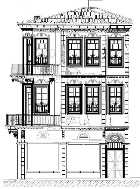
Çizim 4. Yıldız Evi rölöve ön cephe görünüşü (Mimar Osman İnci imzalı restorasyon rölöve projesinden)
