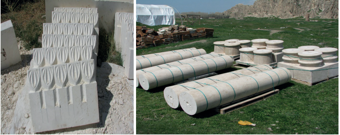
Fotoğraf 18,19. Kaya Çelebi Camii Onarım Malzeme Görünümleri (Kaynak: Ş. Öztürk, 2013)
