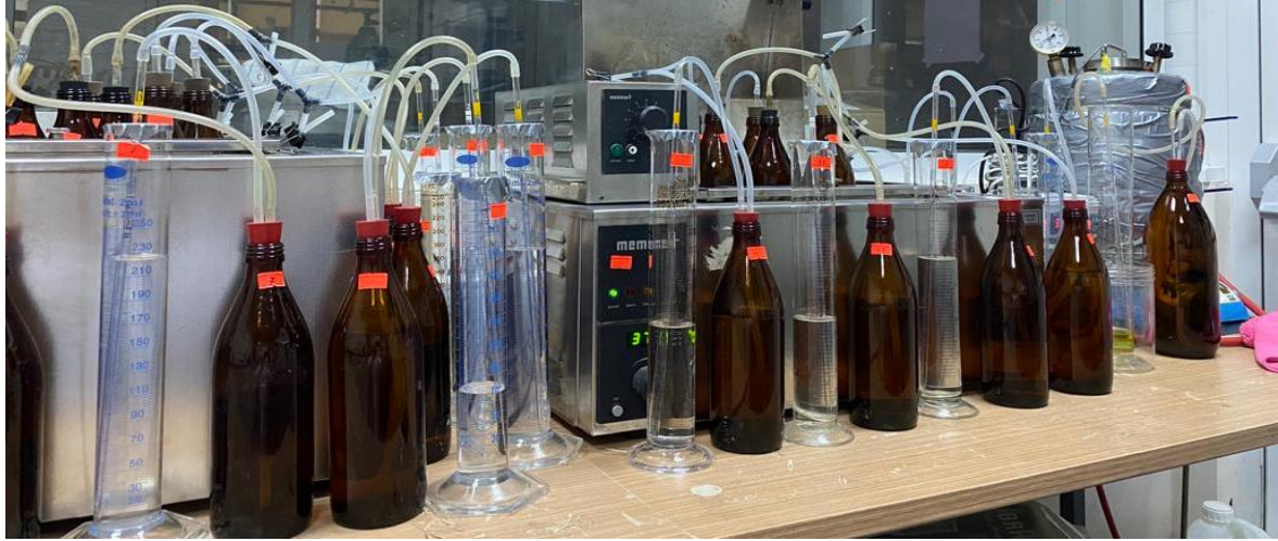
Resim 1. 0,5 L kapasiteli anaerobik sindirim sistemi ve su banyoları
